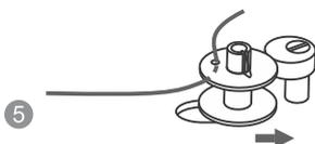
1. Установите катушку на горизонтальный катушкодержатель и прижмите ее катушкодержателем. Используйте маленький катушкодержатель для катушек небольшого размера, для катушек большого размера используйте большой катушкодержатель.
