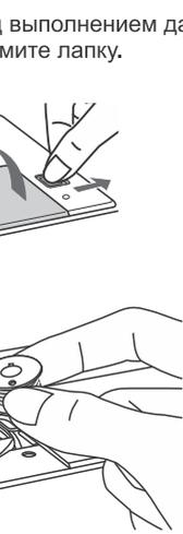
2. Вставьте шпульку в шпулдержатель так, чтобы нить на шпулке сматывалась против часовой стрелки.
